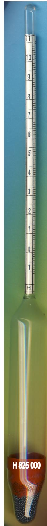
**API Gravity Aräometer nach ASTM**
